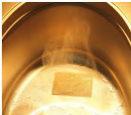
Рис 1. б Фотоизображение «облака» из микрочастиц раствора золь-геля в УЗ ванне.
